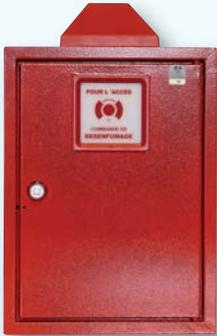
Les commandes de désenfumages au CO<sub>2</sub> **BIZONE (D.C.M.\*, D.A.C.\* ou D.C.M.R.\*)** sont destinés à émettre un ordre d'ouverture ou de fermeture par percussion d'**A.P.S. à usage unique** (cartouches de CO<sub>2</sub>) vers des Dispositifs d'évacuation naturelle des fumées et de la chaleur (**DENFC**).
